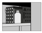
Die Lagerbox dient zur Lagerung von Gefahrstoffen die im Schrank separat unter Verschluss gehalten werden sollen. Die Lagerbox ist in Verbindung mit dem Wannenboden werkseitig im linken Vertikalauszug an oberster Position eingebaut und fest mit dem Rahmen vom Vertikalauszug verschraubt.
