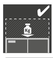
Die V-LINE Sicherheitsschränke sind auflastfähig, sofern der Schrank mit **Artikel HF.L.34938 (Best.-Nr. 40405)** bestellt wurde. Dies Schränke sind dann werkseitig konstruktiv angepasst und außen zusätzlich als auflastfähig gekennzeichnet.
