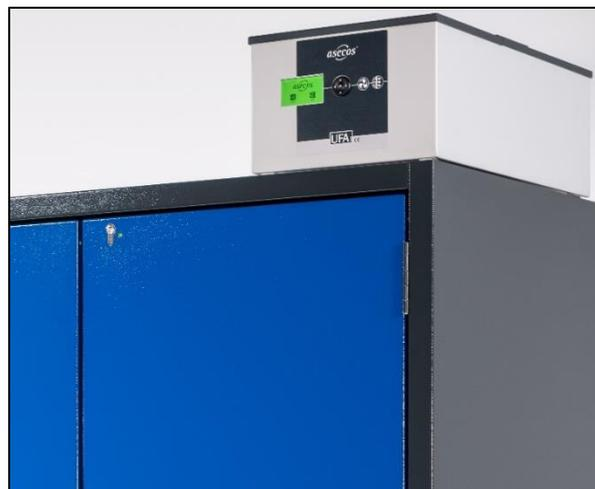
Der steckerfertige Umluftfilteraufsatz Typ UFA.025.030 ist in der Lage Lösemitteldämpfe (Kohlenwasserstoffe) permanent bis zur Filtersättigung zu mehr als 99,999 %, sowohl unter normalen Betriebsbedingungen als auch bei einem simulierten Unfall im Sicherheitsschrank zurück zu halten.
