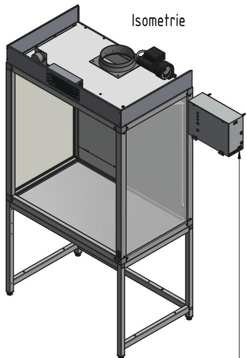
Überwachungsmodul zur Montage außerhalb der EX-Zone inkl. potentialfreiem Schaltkontakt
