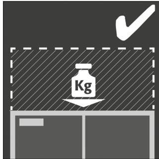
Die V-LINE Sicherheitsschränke sind auflastfähig, sofern der Schrank mit **Artikel HF.L.32864 (Best.-Nr. 38275)** bestellt wurde. Dies Schränke sind dann werkseitig konstruktiv angepasst und außen zusätzlich als auflastfähig gekennzeichnet.
