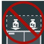
**5** Aufbaut verboten: Auf die Schrankdecke darf kein Aufbau aufgesetzt werden.
