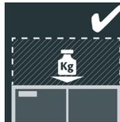
**6** Aufbaut erlaubt: Auf die Schrankdecke darf ein Aufbau gesetzt werden.
